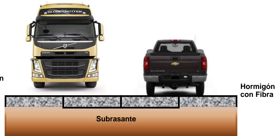
Pavimento Ultradelgado de Ho con fibra
